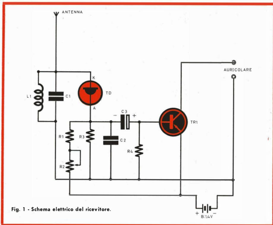
Fig. 1 - Schema elettrico del ricevitore.
