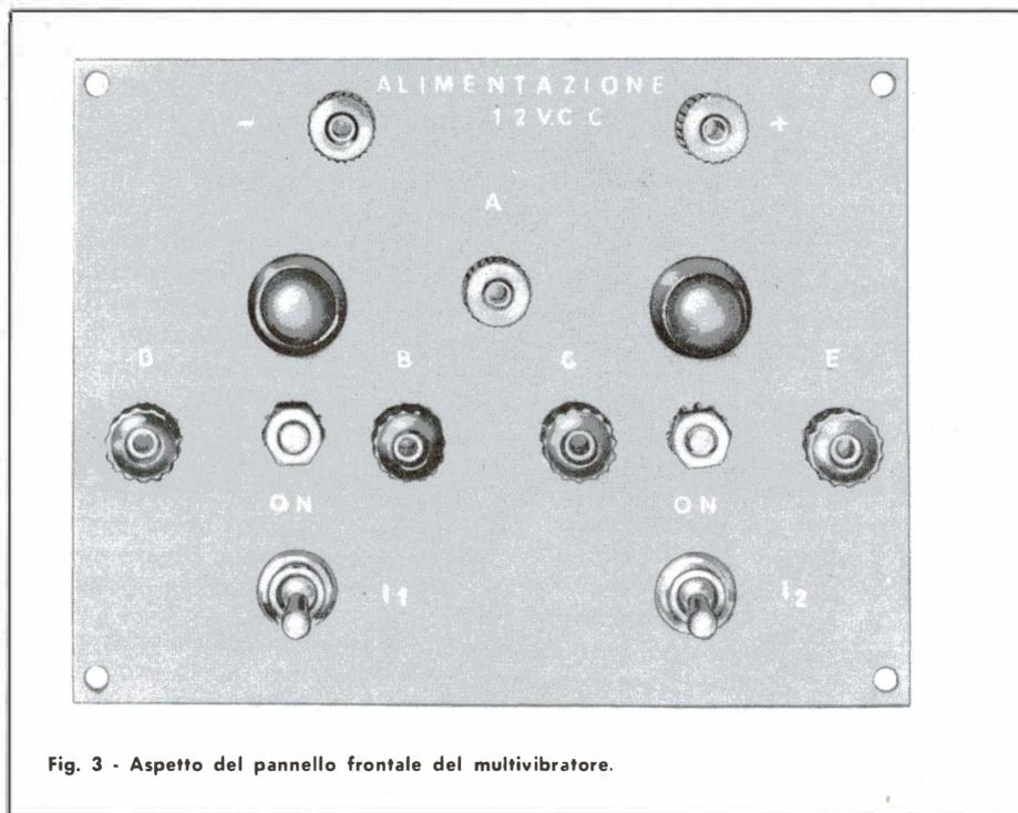
Fig. 3 - Aspetto del pannello frontale del multivibratore.
