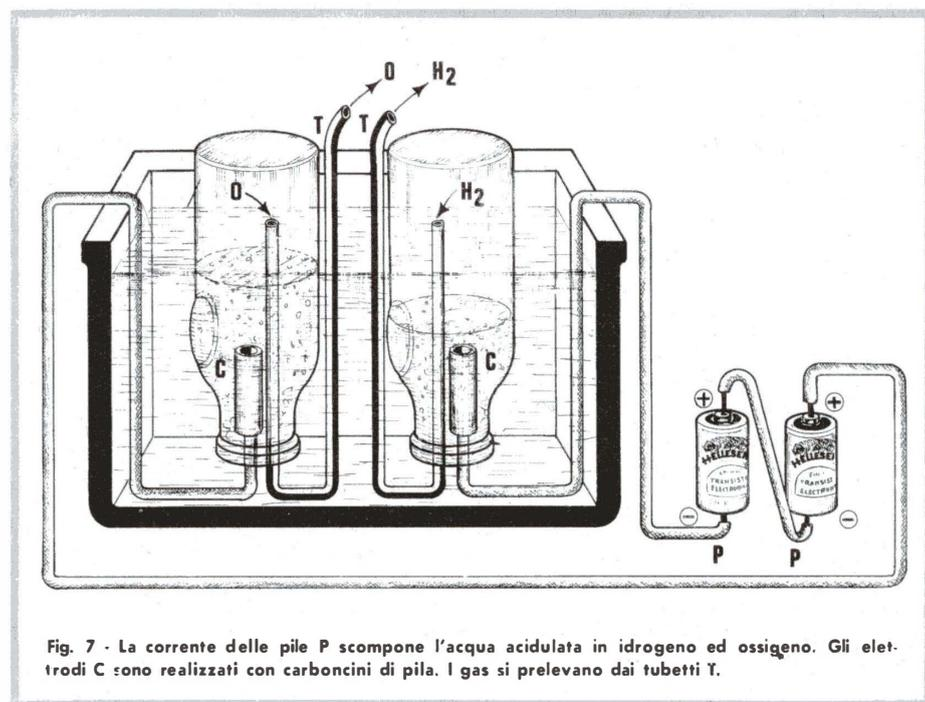
Fig. 7 - La corrente delle pile P scompone l'acqua acidulata in idrogeno ed ossigeno. Gli elettrodi C sono realizzati con carboncini di pila. I gas si prelevano dai tubetti T.
