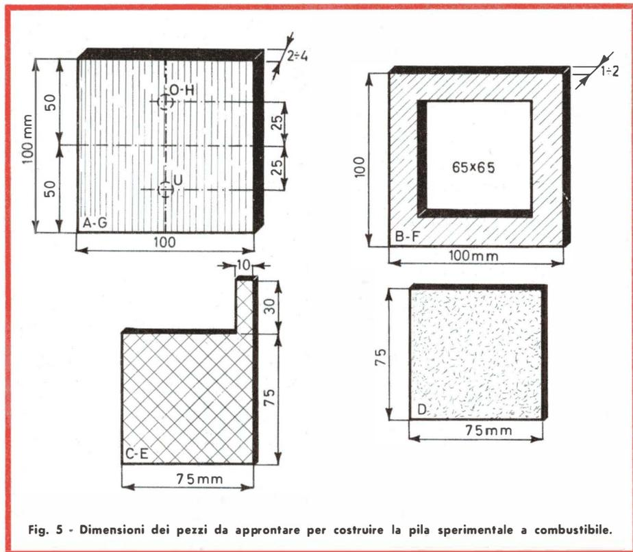
Fig. 5 - Dimensioni dei pezzi da approntare per costruire la pila sperimentale a combustibile.
