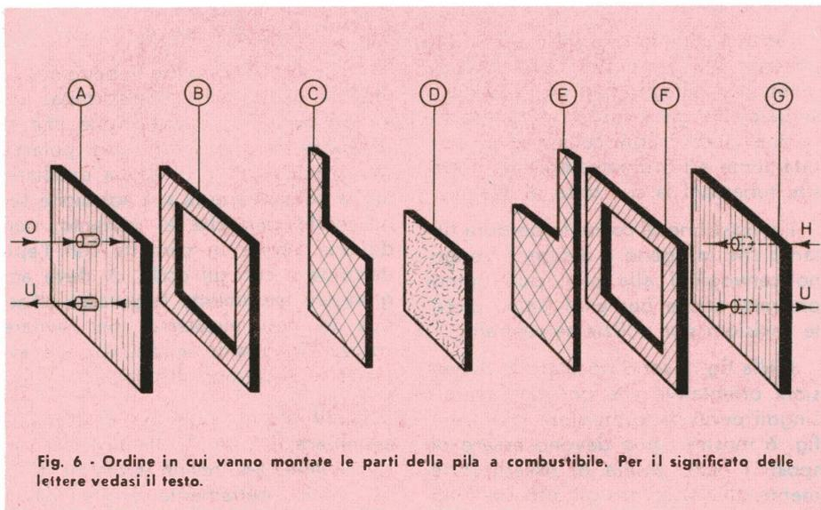
Svilupa una tensione di circa 1,5 V per elemento e 0,5 A/h per ogni 10 g di peso. Ha una durata d'immagazzinaggio superiore alle altre.
