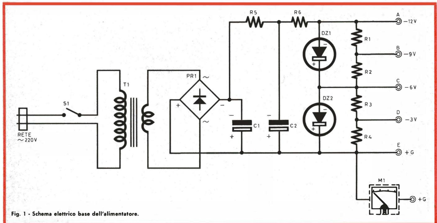
Fig. 1 - Schema elettrico base dell'alimentatore.
