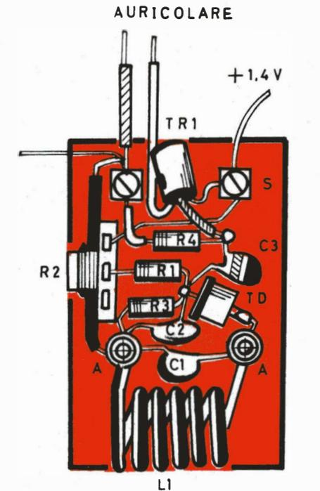
Schema pratico del ricevitore realizzato senza l'ausilio del circuito stampato.
