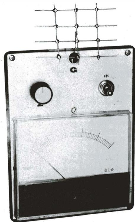
Fig. 1 - Elettroscopio F.E.T.
