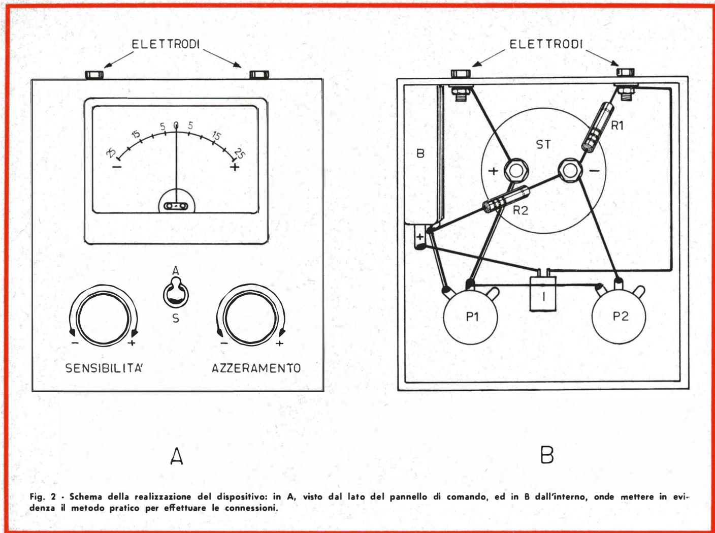
Fig. 2 - Schema della realizzazione del dispositivo: in A, visto dal lato del pannello di comando, ed in B dall'interno, onde mettere in evidenza il metodo pratico per effettuare le connessioni.
