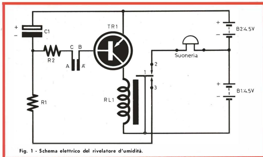
Fig. 1 - Schema elettrico del rivelatore d'umidità.
