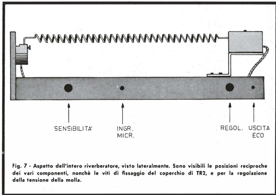
Fig. 7 - Aspetto dell'intero riverberatore, visto lateralmente. Sono visibili le posizioni reciproche dei vari componenti, nonché le viti di fissaggio del coperchio di TR2, e per la regolazione della tensione della molla.
