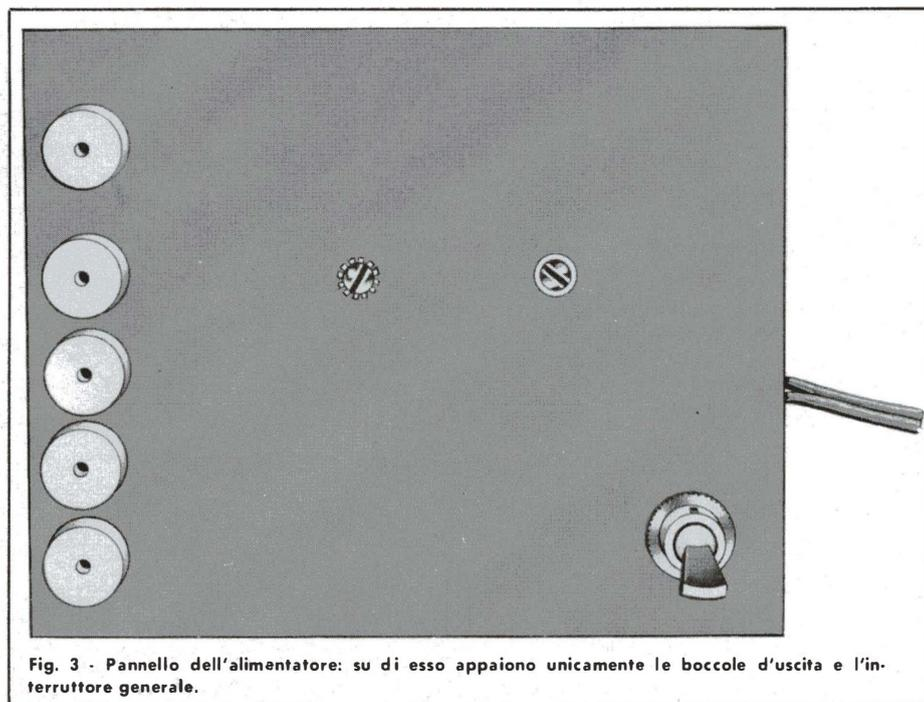
Fig. 3 - Pannello dell'alimentatore: su di esso appaiono unicamente le boccole d'uscita e l'interruttore generale.
