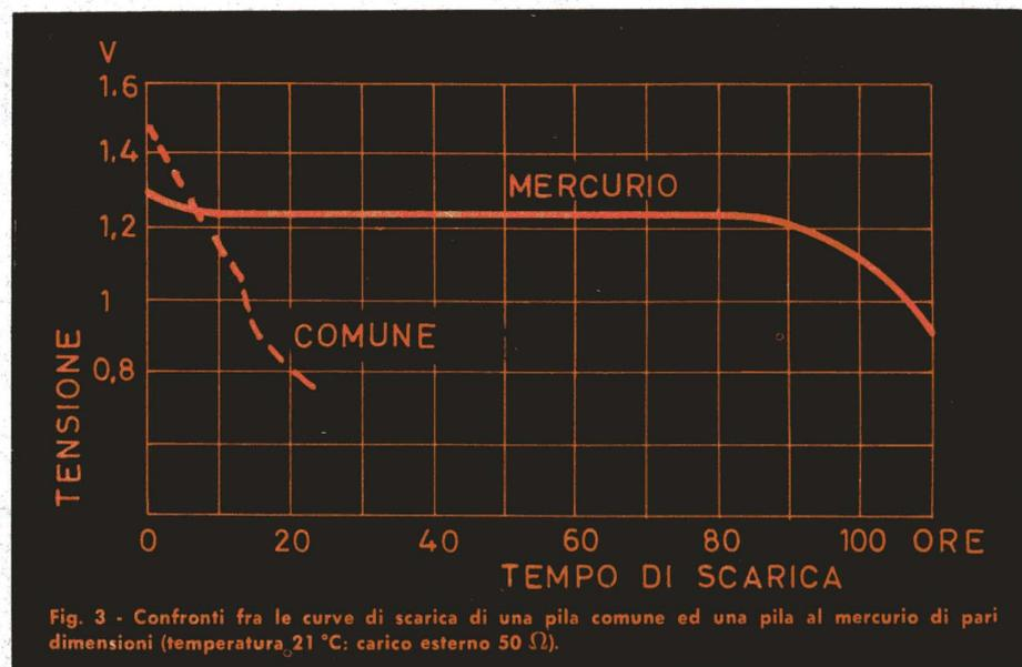
Fig. 3 - Confronti fra le curve di scarica di una pila comune ed una pila al mercurio di pari dimensioni (temperatura 21 °C; carico esterno 50 Ω).
