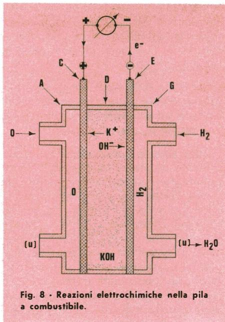
Fig. 8 - Reazioni elettrochimiche nella pila a combustibile.
