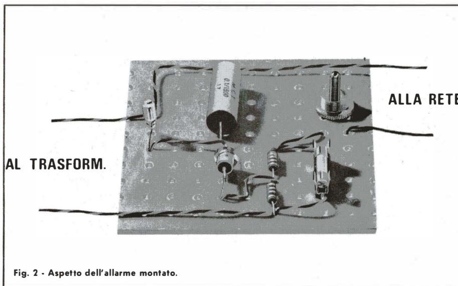
Fig. 2 - Aspetto dell'allarme montato.
