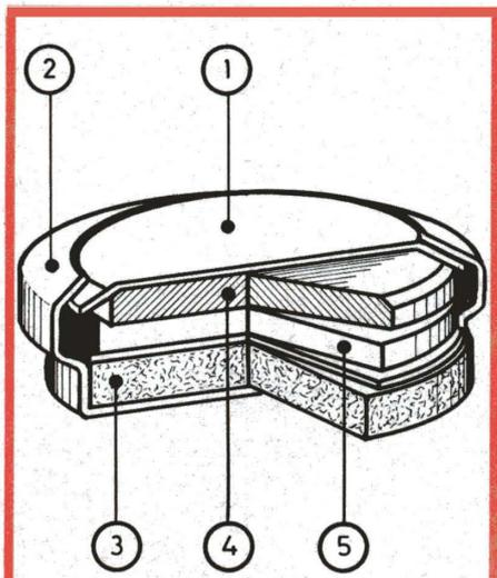
Fig. 2 - Pila al mercurio: 1) elettrodo negativo; 2) elettrodo positivo (acciaio); 3) ossido di mercurio; 4) zinco; 5) idrossido di potassio.
