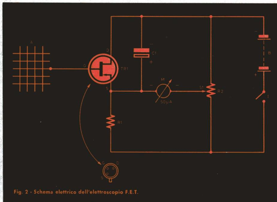
Fig. 2 - Schema elettrico dell'elettroscopio F.E.T.
