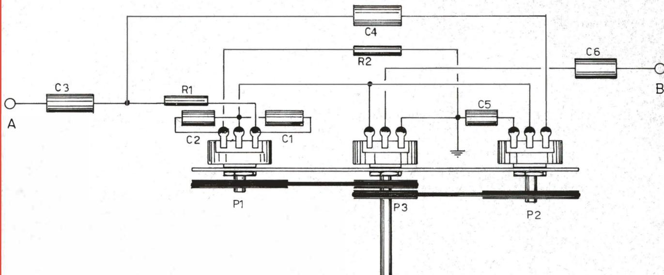
Fig. 5 - Rappresentazione pratica del circuito realizzato, con evidenziazione delle connessioni ai terminali dei potenziometri.
