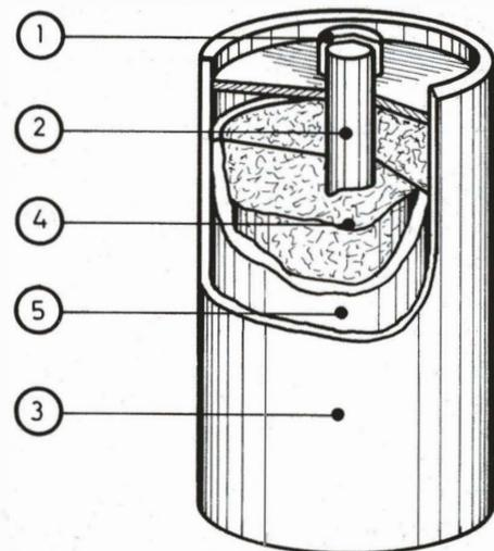
Fig. 1 - Pila comune: 1) cappuccio di metallo; 2) carbone (polo positivo); 3) involucro di zinco (polo negativo); 4) biossido di manganese (depolarizzante); 5) cloridrato di ammonio (elettrolita).
