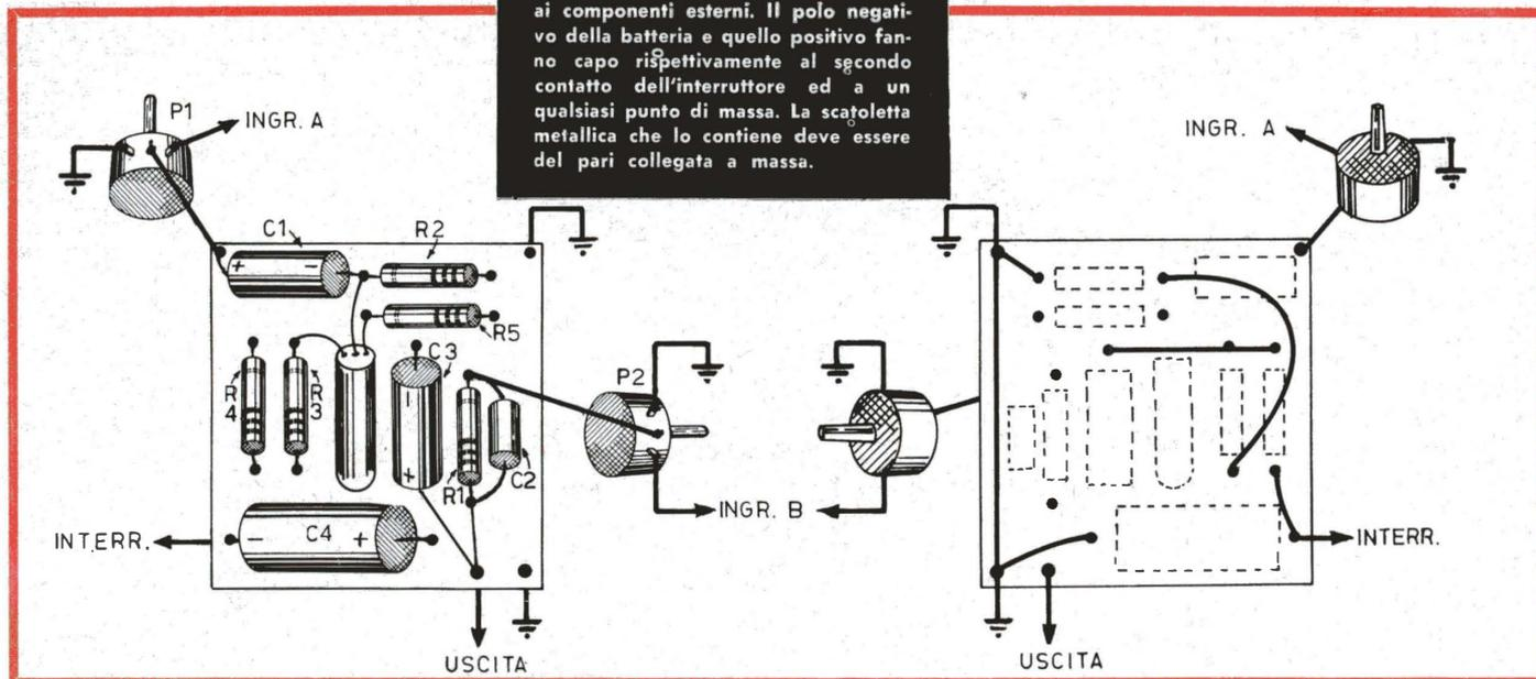
scatoletta, contenente la basetta e la batteria di tipo rettangolare, sono accessibili le tre prese, i due potenziometri e l'interruttore.
