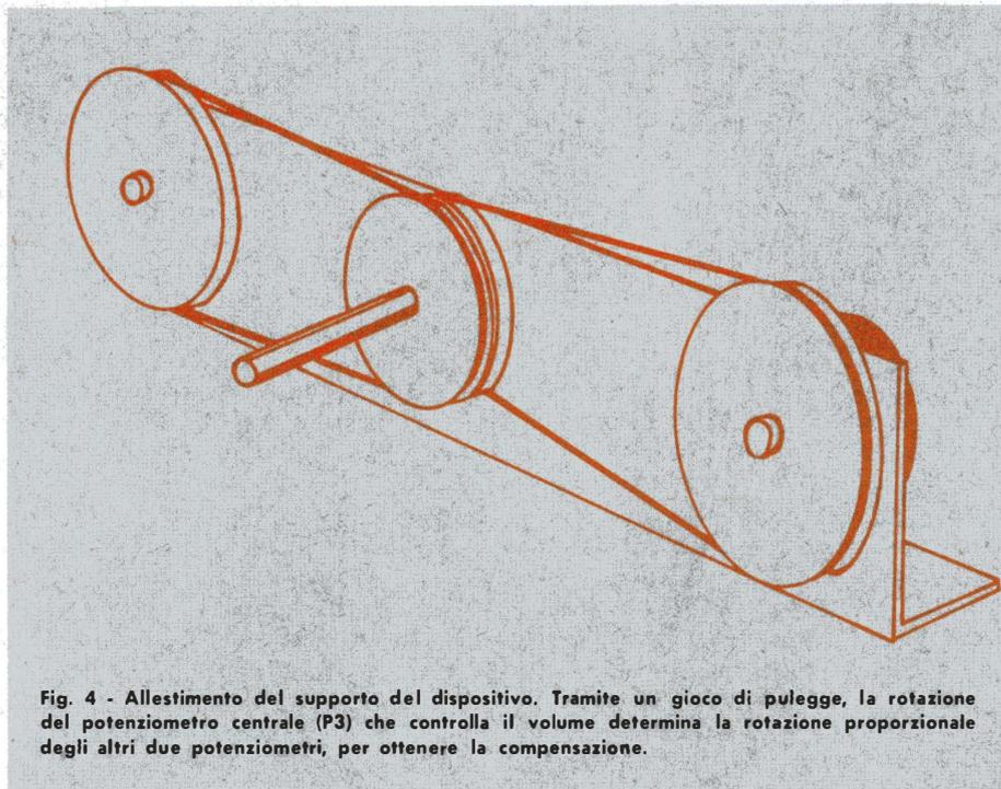
Fig. 4 - Allestimento del supporto del dispositivo. Tramite un gioco di pulegge, la rotazione del potenziometro centrale (P3) che controlla il volume determina la rotazione proporzionale degli altri due potenziometri, per ottenere la compensazione.
