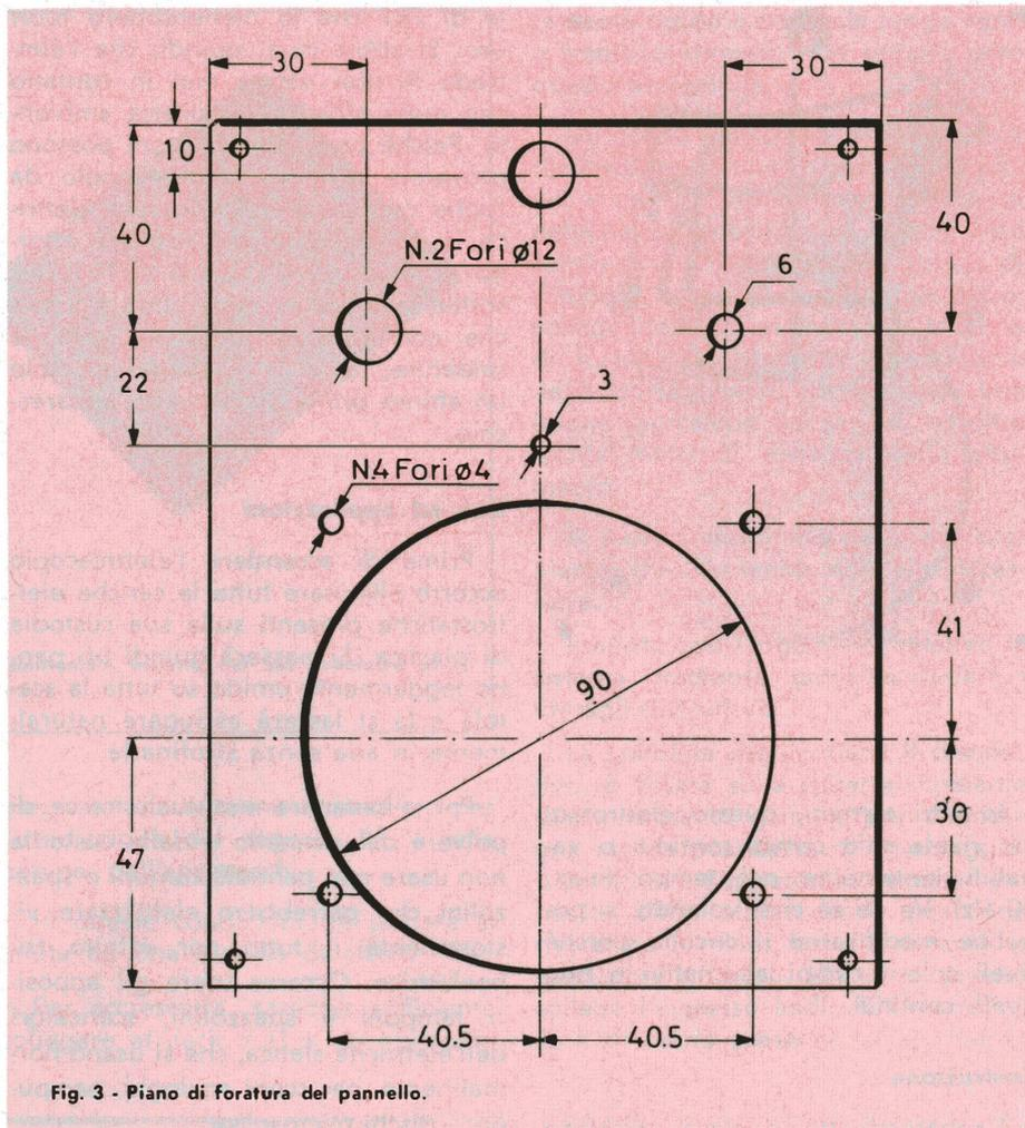
Fig. 3 - Piano di foratura del pannello.
