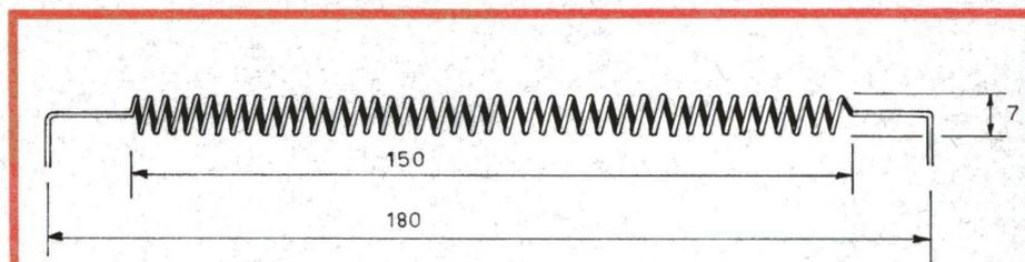
Fig. 4 - Caratteristiche costruttive della molla, che può essere realizzata in acciaio armonico oppure in rame.
