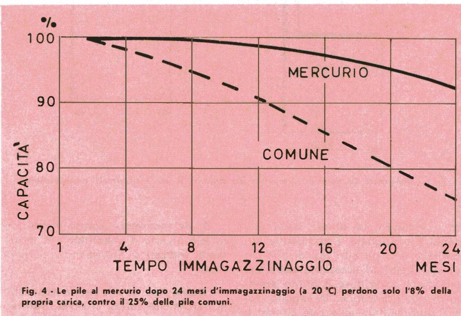
Fig. 4 - Le pile al mercurio dopo 24 mesi d'immagazzinaggio (a 20°C) perdono solo l'8% della propria carica, contro il 25% delle pile comuni.
