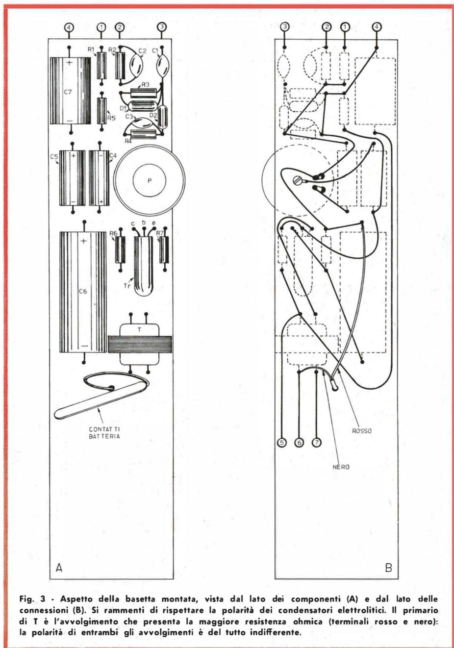
**Fig. 3 - Aspetto della basetta montata, vista dal lato dei componenti (A) e dal lato delle connessioni (B). Si rammenti di rispettare la polarità dei condensatori elettrolitici. Il primario di T è l'avvolgimento che presenta la maggiore resistenza ohmica (terminali rosso e nero): la polarità di entrambi gli avvolgimenti è del tutto indifferente.**
