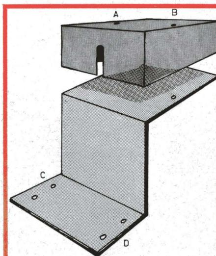
Fig. 3 - Struttura del supporto mobile per il trasduttore a cristallo TR2. Con il suo spostamento longitudinale rispetto alla base viene regolata la tensione della molla.
