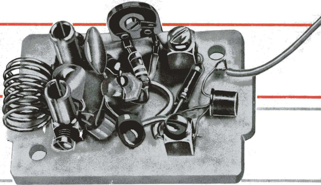
desime fa capo il condensatore di sintonia; C1. Il punto ove s'incontra il maggior numero di connessioni è l'anodo del diodo: qui giungono R1, R3, C2, C3. Per facilitare la saldatura, sul reoforo del « TD » è infilato un rivetto da calzolaio, e nel rivetto sono infilati a loro volta i conduttori provenienti dalle altre parti.
