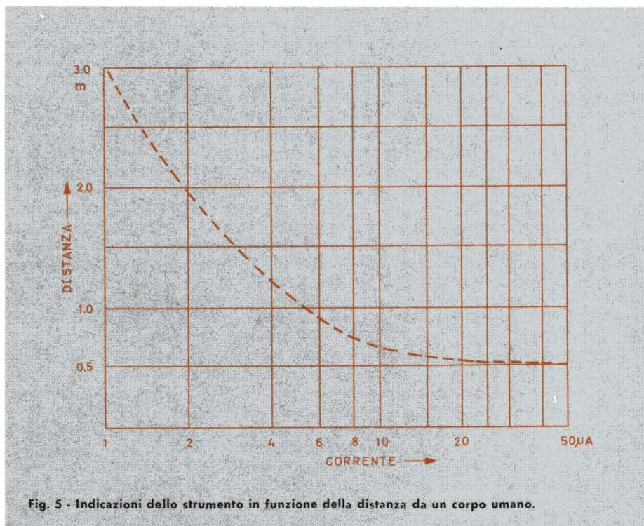
Fig. 5 - Indicazioni dello strumento in funzione della distanza da un corpo umano.
