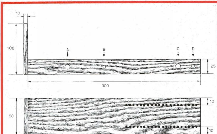
Fig. 2 - Criteri costruttivi della base di supporto principale, che può essere realizzata in legno. La parte inferiore è interamente vuota, e può contenere l'amplificatore a transistor, ed i vari comandi e raccordi. Per evitare rumori di fondo indesiderabili, è bene in tal caso foderare l'interno con una sottile lastra di alluminio, collegata opportunamente alla massa di uscita.
