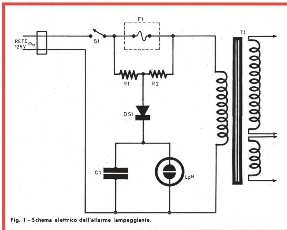
Fig. 1 - Schema elettrico dell'allarme lampeggiante.
