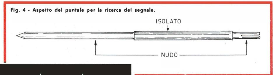
Fig. 4 - Aspetto del puntale per la ricerca del segnale.
