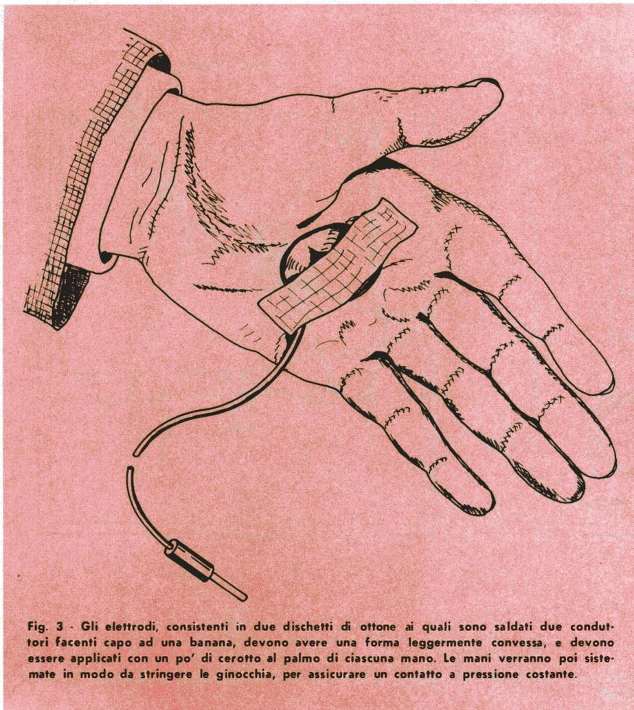
Fig. 3 - Gli elettrodi, consistenti in due dischetti di ottone ai quali sono saldati due conduttori facenti capo ad una banana, devono avere una forma leggermente convessa, e devono essere applicati con un po' di cerotto al palmo di ciascuna mano. Le mani verranno poi sistemate in modo da stringere le ginocchia, per assicurare un contatto a pressione costante.
