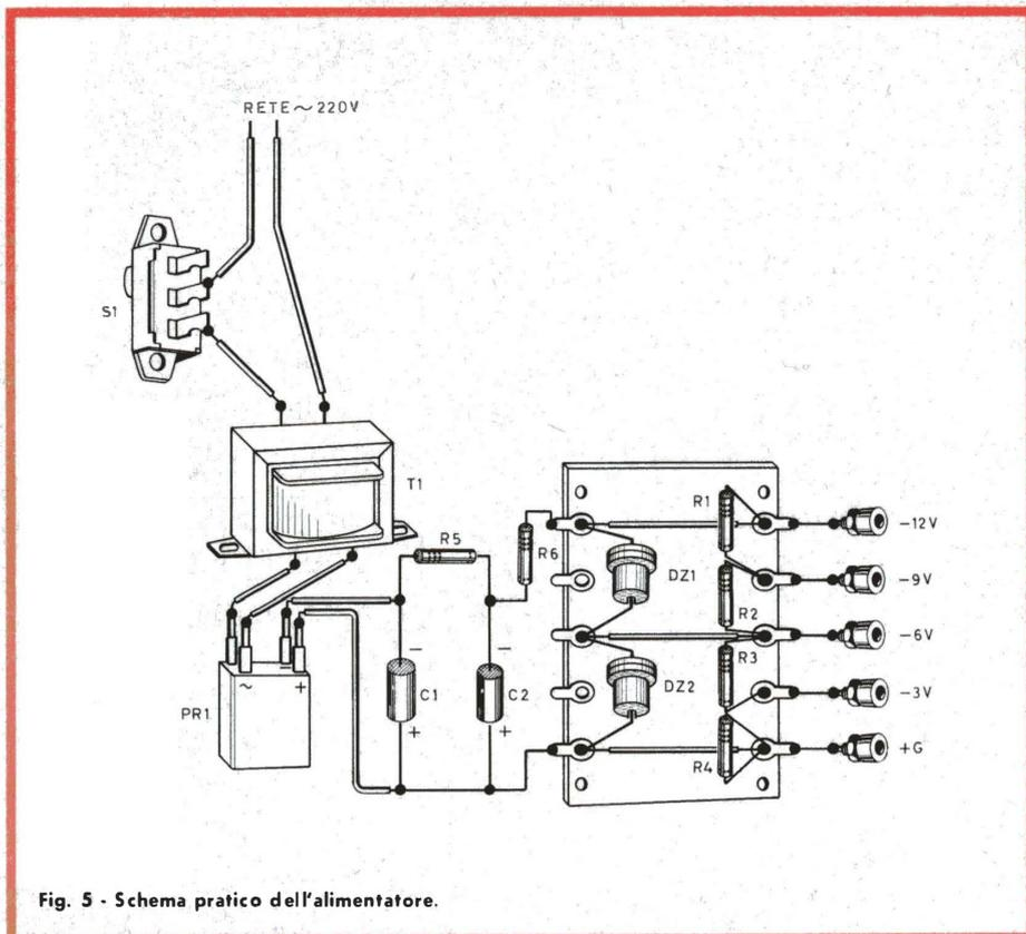
Fig. 5 - Schema pratico dell'alimentatore.
