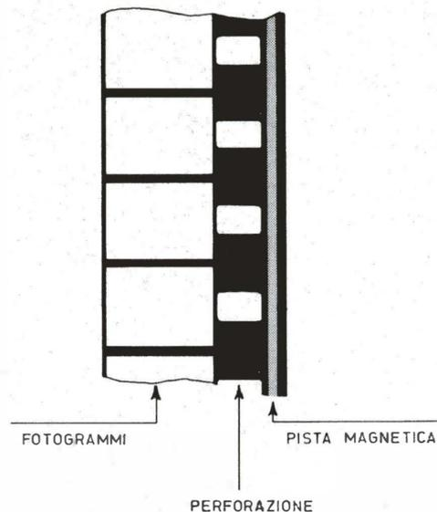
Fig. 1 - La pista magnetica è della medesima natura del nastro magnetico, e consiste in una sottilissima striscia di tale materiale, che viene applicata mediante incollaggio sulla superficie lucida della pellicola (opposta a quella recante la emulsione), a fianco della perforazione.
