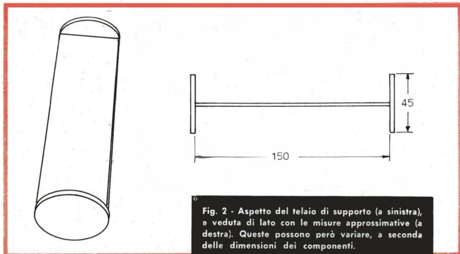
Fig. 2 - Aspetto del telaio di supporto (a sinistra), e veduta di lato con le misure approssimative (a destra). Queste possono però variare, a seconda delle dimensioni dei componenti.
