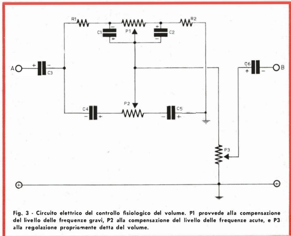
**Fig. 3 - Circuito elettrico del controllo fisiologico del volume. P1 provvede alla compensazione del livello delle frequenze gravi, P2 alla compensazione del livello delle frequenze acute, e P3 alla regolazione propriamente detta del volume.**
