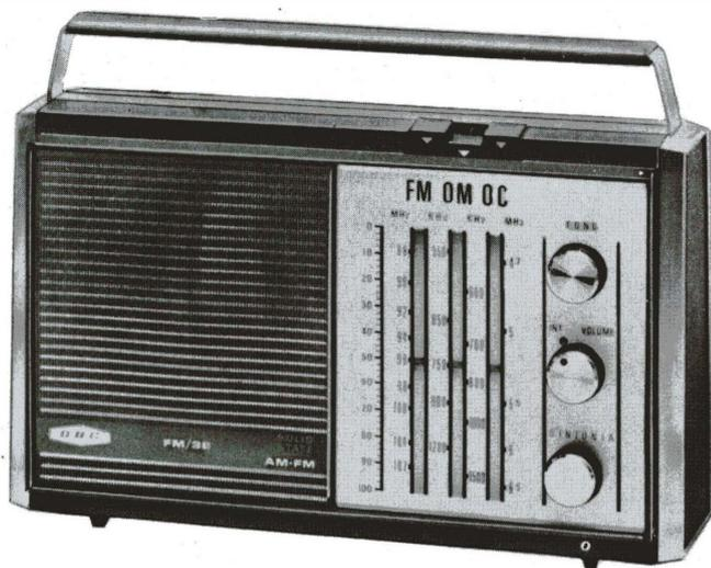
Le principali caratteristiche del radiorecettore portatile a transistor per FM - OM - OC FM/38 « ODIC » sono: 8 transistor + 5 diodi + 1 raddrizzatore. Antenna: in ferroxube per OM-OC; telescopica per FM. Presa per antenna esterna. Selezione gamme d'onda a tastiera. Controlli di volume e di tono a regolazione continua. Potenza di uscita 800 mW. Alimentazione mista: in c.a. 110 ÷ 220 V; in c.c. mediante 2 pile da 4,5 V. Dimensioni: 315 x 190 x 90. Peso: 1800 g.
