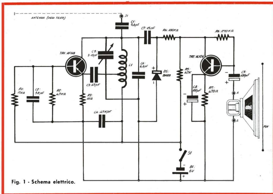
Fig. 1 - Schema elettrico.
