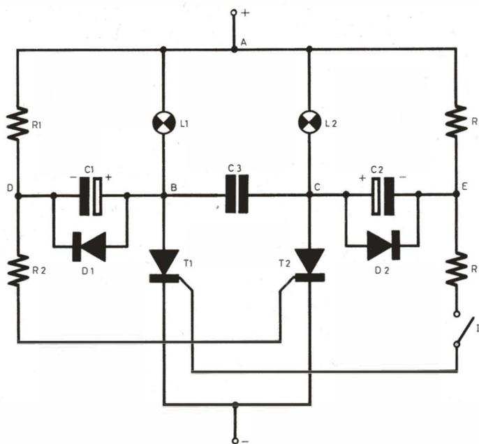
Fig. 1 - Schema elettrico del multivibratore.
