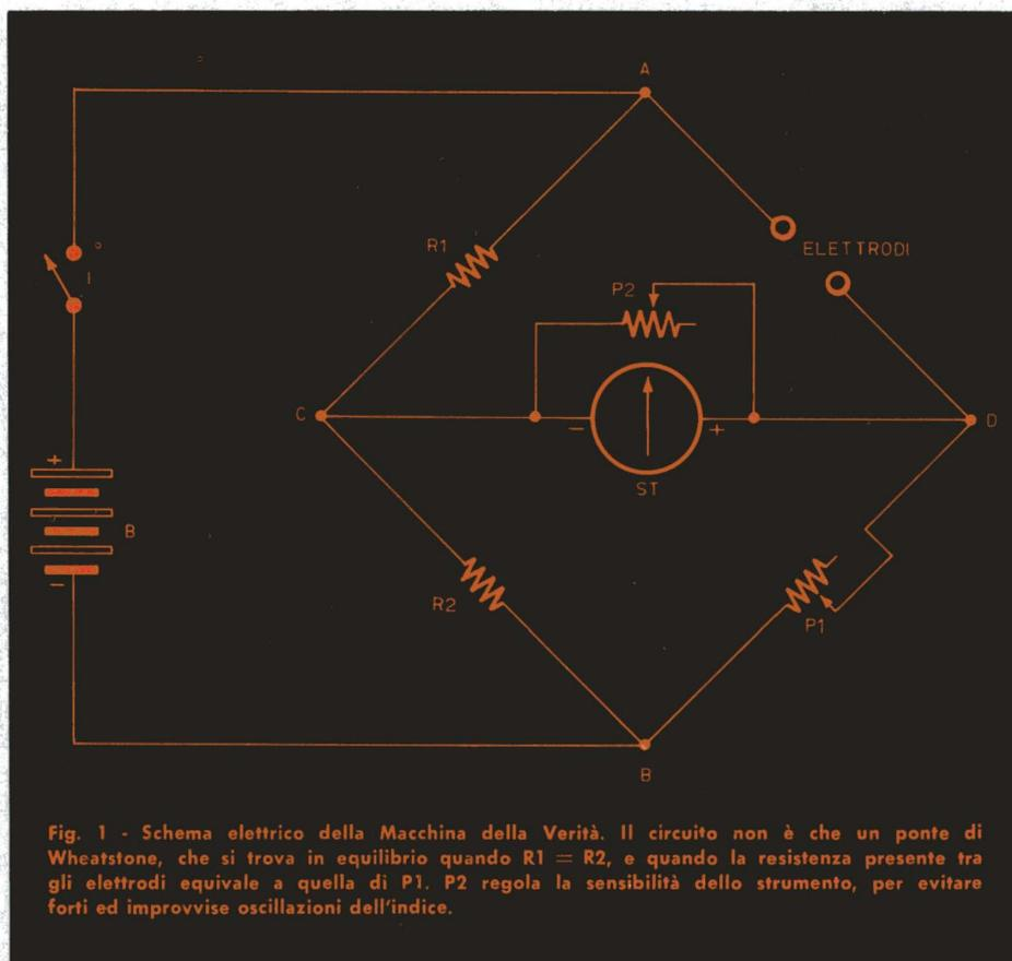
Fig. 1 - Schema elettrico della Macchina della Verità. Il circuito non è che un ponte di Wheatstone, che si trova in equilibrio quando  $R1 = R2$ , e quando la resistenza presente tra gli elettrodi equivale a quella di  $P1$ .  $P2$  regola la sensibilità dello strumento, per evitare forti ed improvvise oscillazioni dell'indice.
