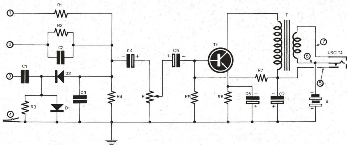
Fig. 1 - Circuito elettrico del cercasegnali.
